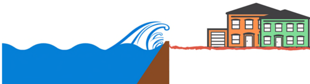
Fig. 2. Exemple de franchissement
